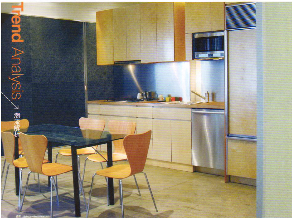
廚房的櫃體木作部份，運用便宜的樺木合板，洗手檯面則採用富美家飾板的心材，呈現棕櫚木的質感。在側牆漆上黑色油亮的防水漆Quiet Pro。
